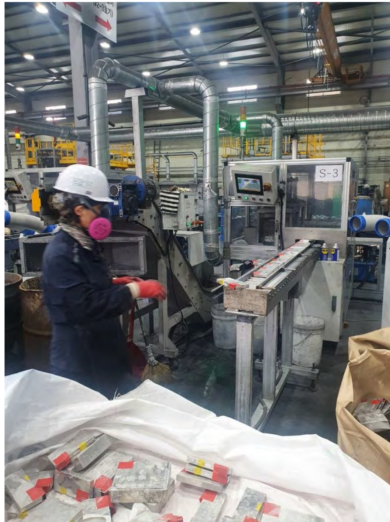
Abbildung 2-6: Beispiel für die Cell Auto Cutting Maschine (Quelle: SungEel)
