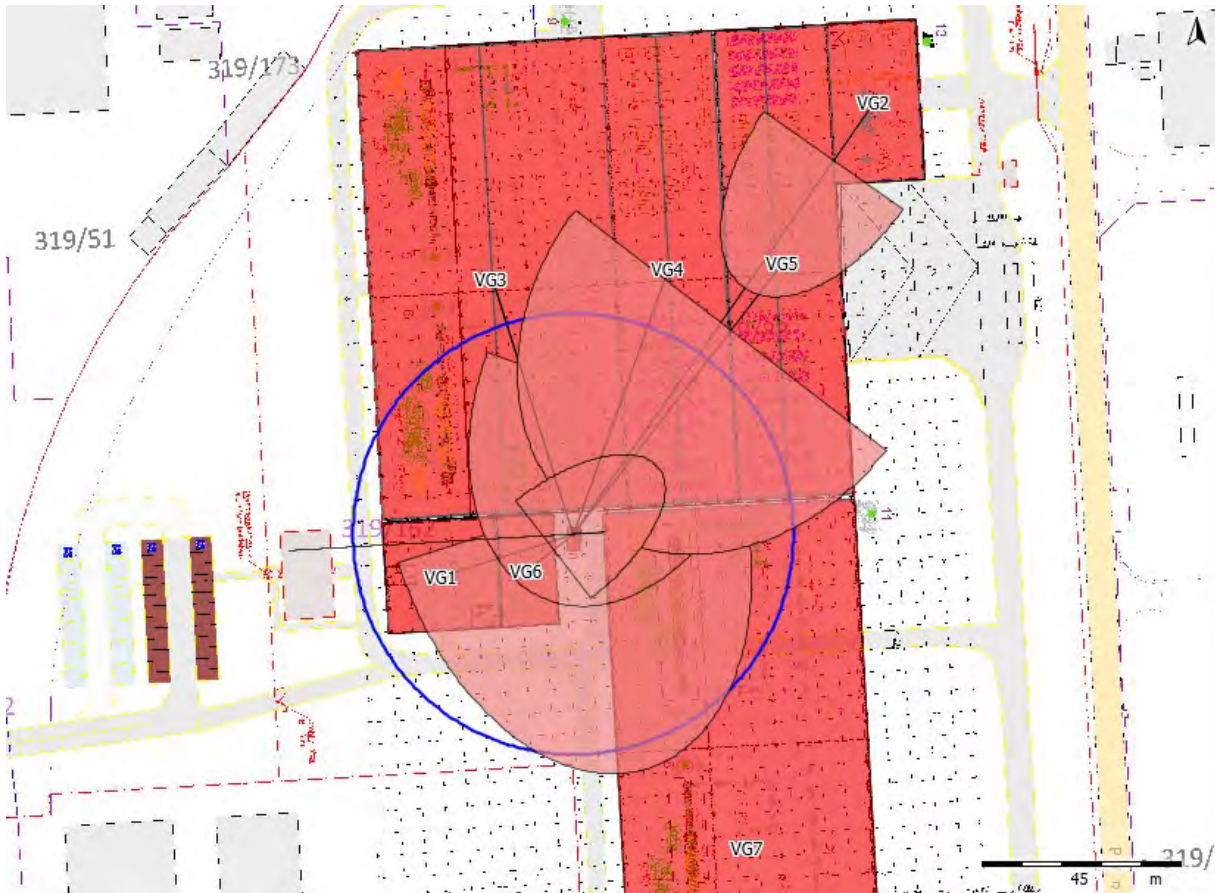
Abbildung A2-19: Darstellung der berücksichtigten Gebäude, der Rezirkulationszone (rot) und des Einwirkungsbereiches (blauer Kreis)
