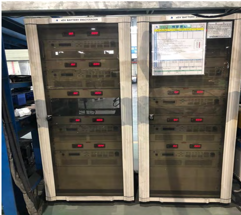
Abbildung 2-3: Beispiel für Entladegerät (Quelle: SungEel)
